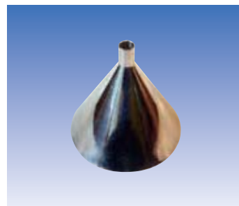
機械部品 ロート サイズ：130φ×H130㎜ 材質：SUS 304 厚み：0.7㎜
