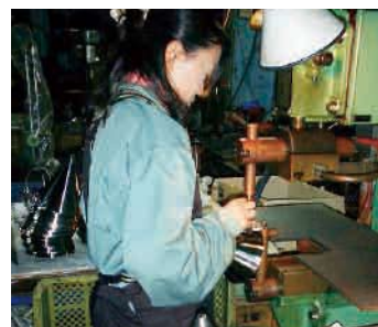
スポット溶接加工
